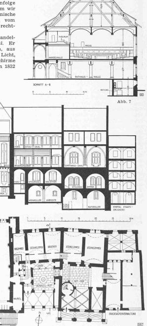
Abb. 2. Erdgeschoss. — Darüber Abb. 3. Längsschnitt des umgebauten Rathauses — 1:500
