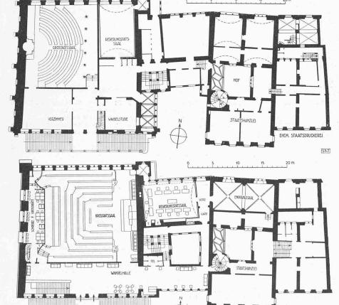
Abb. 4. Obergeschoss des umgebauten Rathauses. — Darüber Abb. 5. Bisheriger Zustand. — 1:500
