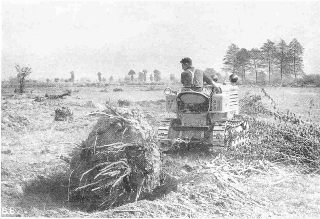
Abb. 7. Ausreissen von Wurzelstöcken mit dem Raupentraktor
