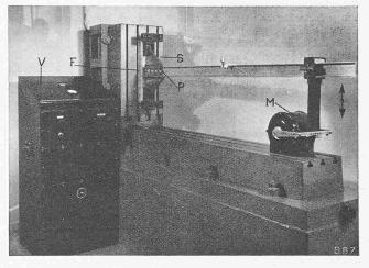
Abb. 1. Knotenpunkt-Schwingmaschine von Ing. E. Schiltknecht (Zürich)
