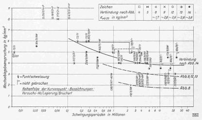
Abb. 2. Dauerwechselbiegefestigkeit autogen geschweisster Anticorodal-Knotenpunkt-Verbindungen
