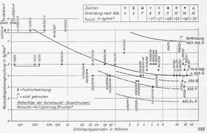
Abb. 3. Dauerwechselbiegefestigkeit autogen geschweisster Avional- und Peraluman-Knotenpunkt-Verbindungen
