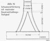
Abb. 8 bis 15. Autogen bzw. elektrisch geschweisste I-Profil-Knotenpunkt-Verbindungen
