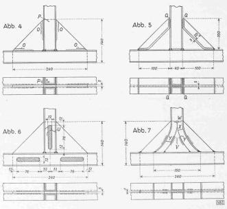
Abb. 4 bis 7. Autogen geschweisste E-Profil Knotenpunktverbindungen
