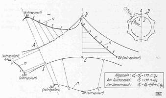
Abb. 9. Spannungsverteilung in sternförmiger Scheibe, Innendruck qu
