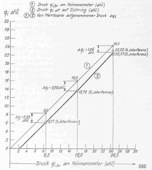
Abb. 7. Eichversuch am Eichring mit Innendruck
