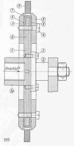
Abb. 2 Vorrichtung für Innendruckversuche
