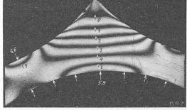
Abb. 8. Interferenzen einer sternförmigen Scheibe unter Innendruck qi
