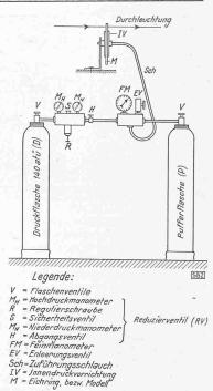
Abb. 3. Schema der Versuchsanordnung
