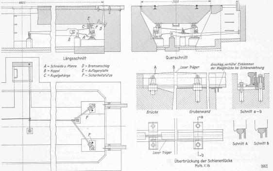
$\textbf{Abb. 3. Waggon- und Fuhrwerk-Waage System Wirth, gebaut von Hans Boch, Waagenfabrik, Z\"{u}rich.-1:60 \ und \ 1:15 \ and \ 1:15 \ an$
