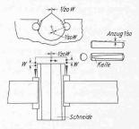
Abb. 9. Schneide mit Zylindersitz
