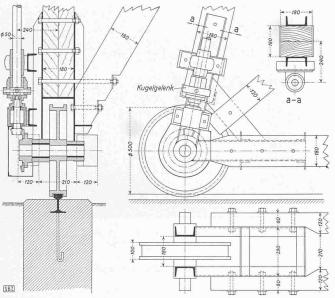
Abb. 4. Gelenkiger Antrieb am Fuss der starren Stütze. - 1:20
