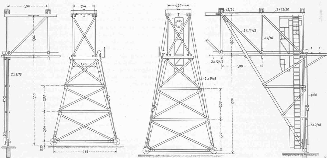
Abb. 2. Ausbildung und Abmessungen der beiden Stützen, links die Pendelstütze. — Massstab 1:150
