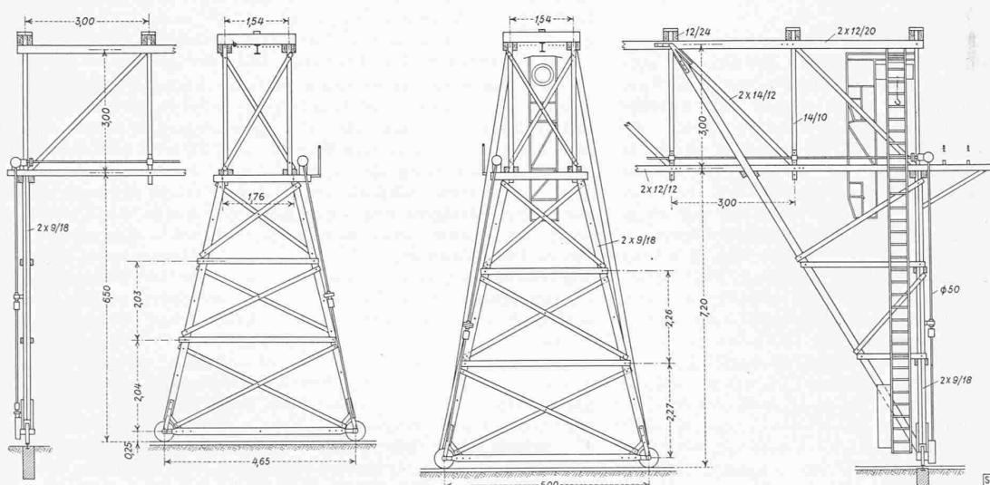
Abb. 2. Ausbildung und Abmessungen der beiden Stützen, links die Pendelstütze. — Maßstab 1:150
