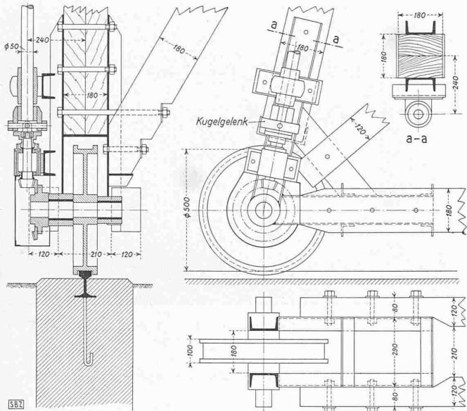
Abb. 4. Gelenkiger Antrieb am Fuss der starren Stütze. — 1:20
