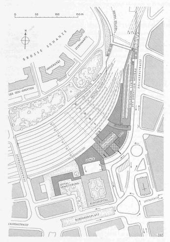
Abb. 11. Niveau-Bahnhof unter Inanspruchnahme des hintern Hofes des Burgerspitals; tiefliegende Einführung der S.Z.B. - 1:4000
