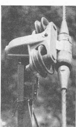
Verbindung (mit Leitrollen) zwischen Seil und Gehänge
