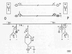
Abb. 6. Prinzipschaltung des eingeleisigen Blocks ohne Zwischenblockstelle mit Geleiseisollerung
