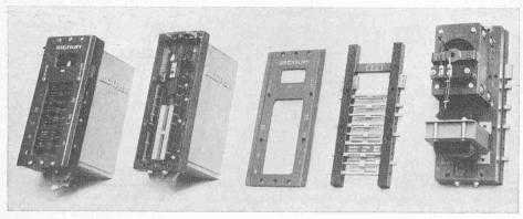
Abb. 8. Polarisiertes Relais für Signalsteuerung, System «Signum», Wallisellen
