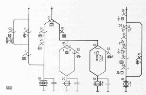
Abb. 9. Schaltung für Zählerprüfung
