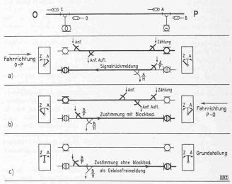
Abb. 16. Die drei Betriebszustände beim eingeleisigen Block ohne Zwischenblockstelle, mittels Achszählung
