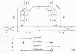
Abb. 1. Prinzip-Schema des Wechselstromblocks (Handblock) für zweigeleisige Strecken
