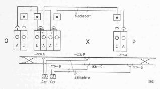
Abb. 3. Anordnung der Apparate bei unbesetzter Blockstation in Tunnelmitte
