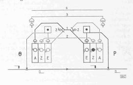
Abb. 2. Prinzip-Schema des eingeleisigen Wechselstromblocks mit freier Zustimmungsrückgabe
