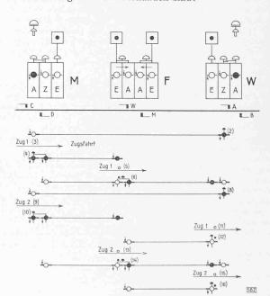
Abb. 5. Reihenfolge der Vorgänge bei einer Zugsfahrt beim Wechselstromblock alter Bauform bei eingeleisigem Block mit Zwischenblockstelle
