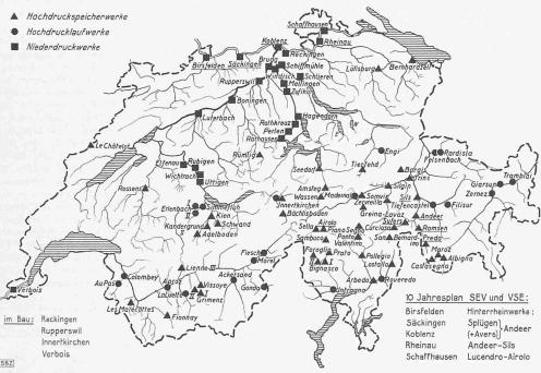
Projektierte ausbauwürdige und im Bau befindliche Wasserkraftwerke der Schweiz von min. 5000 kW Ausbauleistung, Speicherwerke mit Winterenergie-Gestehungspreisen von max. 6 Rp./kWh. Nach einer Zeichnung der «Schweiz. Wasser- u. Energiewirtschaft», von uns ergänzt
