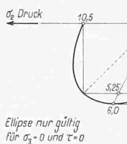
Abb. 18. Zulässige Spannungen stumpf-geschweisster, bearbeiteter Nähte von Dampfkesseln und Druckbehältern. Zweiaxige Spannungszustände. EMPA 1941
