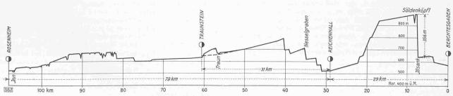
Abb. 2. Längenprofil der alten Soleleitungen von Berchtesgaden bis Traunstein und Rosenheim. Längen 1:600 000, Höhen 1:20 000
