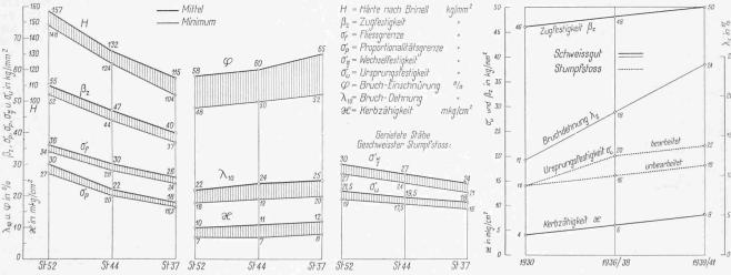
Abb. 8. Statische und dynamische Festigkeits- und Verformungseigenschaften normengemässer Baustähle St 52 bezw. Ac 54, St 44 und St 37. Stäbe voll, genietet, stumpf geschweisst. EMPA-Versuche 1935/1940
