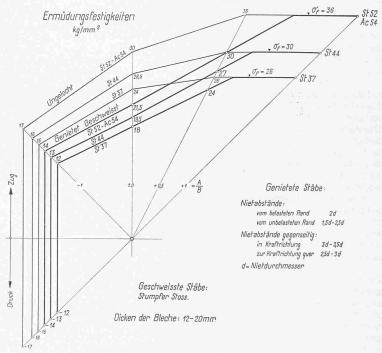
Abb. 9. Statische und dynamische Festigkeits- und Verformungseigenschaften normengemässer Baustähle St 52 bezw. Ac 54, St 44 und St 37. Stäbe voll, genietet, stumpf geschweisst. EMPA-Versuche 1935/1940
