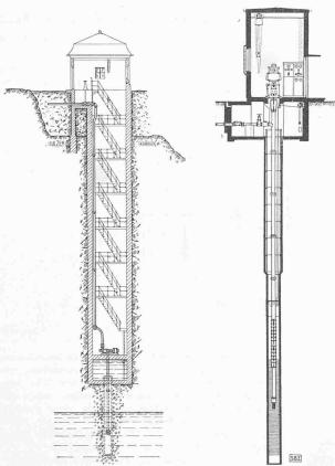
Abb. 1. Horizontalachsige Zentrifugalpumpe in begehbarem Schacht
