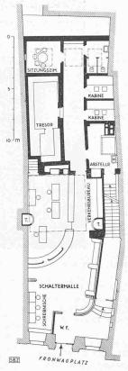
Abb. 3. Umgebautes Erdgeschoss 1:300
