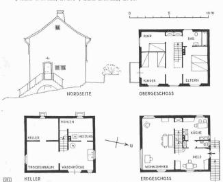
Abb. 5. Grundrisse Haus «A», Masstab 1:300
