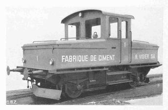
Abb. 1. Oerlikon-Akkumulatoren-Lokomotive von 100 PS
