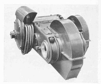
Abb. 2. Ein 50 PS-Oerlikon-Traktionsmotor für die Rangierlokomotive nach Abb.  $\mathbf{1}$
