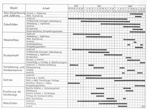
Abb. 8. Bis Juni 1942 tatsächlicher Baufortschritt, ab Juli Bauprogramm des Kraftwerkes Innertkirchen
