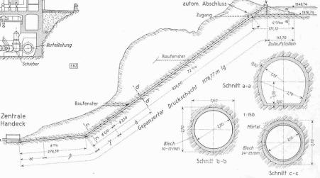
Abb. 9. Druckschacht der obern Stufe, Zentrale Handeck, Masstab 1:10000, Schnitte 1:150
