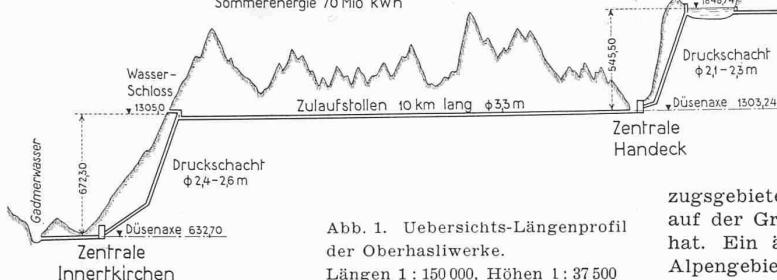
Abb. 1. Uebersichts-Längenprofil der Oberhasliwerke.
