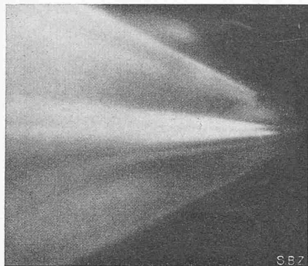
Abb. 7. Um 15° abgelenkter Strahl. Nadelhub 20°
