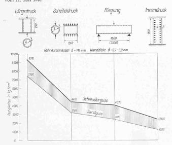
Abb. 6. Schleuderguss-Rohre des Ludw. von Roll Werkes Choindez. Festigkeitseigenschaften der Schleuderguss- und Sandguss-Rohre
