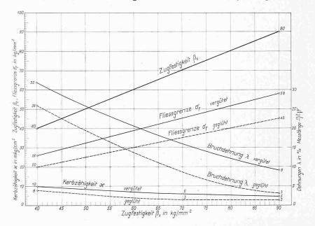
Abb. 7. Stahlguss. Zugfestigkeit, Streckgrenze, Bruchdehnung und Kerbzähigkeit. Hochwertige, legierte Stahlgussarten  $\beta z \ge 70 \text{ kg/mm}^2$  weisen höhere Kerbzähigkeiten auf
