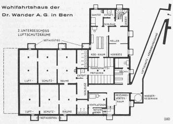
Abb. 14. 2. Untergeschoss mit den Luftschutzräumen. - 1:400
