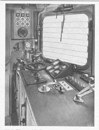
Abb. 8. Führerstand für Einmannbedienung der BBC-Gasturbolokomotive der Schweiz. Bundesbahnen Neben den bahntechn. Apparaten kann der Führer auch die den Betrieb der Gasturbine überwachenden Instrumente gut überblicken
