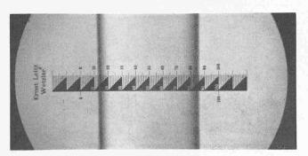
Abb. 5. Freier Strahl bei lam. Strömung.  $d=0.81\,\mathrm{mm}$  (Vergr. rd. 45fach)
