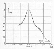
Abb. 4. Relative Intensitäten bei Wasser - Laminar.  $R_e = 1039 t = 21,2 \,{}^{\circ}\,C$ - Turbulent.  $R_e = 6522$  t = 11,8°C $2\vartheta=$  halber Oeffnungswinkel d. Streukegels  $\lambda = 1,539$  A = Wellenlänge d. Röntgenstrahls
