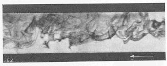
Abb. 3. Strömung turbulent, Re = 6820
