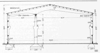
Abb. 4. Späteres Projekt in Eisenbeton. — Masstab 1:300
