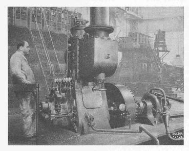
Abb. 17. Ansicht eines aufgeladenen einzylindrigen Einkolben-Zweitaktmotors von 420 mm Bohrung und 500 mm Hub. Die Leistung betrug bei 2 ata Aufladung 692 PSe bei 450 U/min und einem eff. Mitteldruck von 10 kg/cm²
