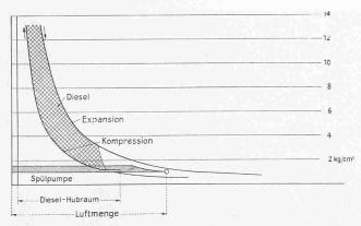
Abb. 10. Unterer Teil des Indikator-Diagramms eines nicht aufgeladenen Zweitakt-Dieselmotors
