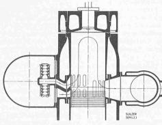
Abb. 2. Schema der Sulzer-Nachladung. Der Zylinder wird nach beendigter Spülung durch die oberen Einlasschlitze bis auf den Spülluftdruck nachgeladen
