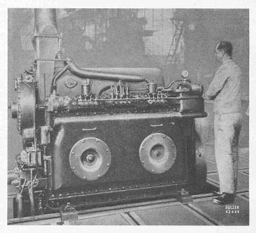
Abb. 14. Ansicht des ersten aufgeladenen Sulzer-Zweitaktmotors 4ZGA19 mit gekuppelter Abgasturbine, mit dem ein effektiver Mitteldruck von 12 kg/cm² erreicht wurde (Zylinderzahl 4, Bohrung 190 mm, Hub  $2 \times 300$  mm) Der Aufladedruck betrug 2 ata, die Stundenleistung 1370 PSe bei 750 U/min und 12 kg/cm<sup>8</sup> effektivem Mitteldruck
