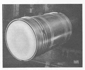
Abb. 13. Einwandfreier Zustand des Auspuffkolbens von 190 mm ∅ eines Gegenkolben-Zweitaktmotors nach durchgeführtem 48-stündigem Ueberlastversuch mit Aufladung auf 2 ata, bei dem ein effektiver Mitteldruck von 13 kg/cm² durchgehalten wurde
