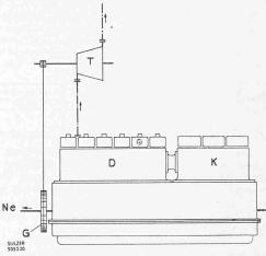
Abb. 5. Schema eines «hochgeladenen» Zweitakt-Dieselmotors mit direkt gekuppeltem Kolbenkompressor u. mechan. Uebertragung zwischen Abgasturbine u. Dieselmotor. Die Abgasturbine ist durch ein Getriebe (schemat. als Kettengetriebe dargestellt) mit der Kurbelwelle des Zweitaktmotors gekuppelt D Zweitakt-Dieselmotor, K Kompressor, T Abgasturbine, G Getriebe zwischen Dieselmotor u. Abgasturbine, Ne Nutzleistung abgebende Welle
