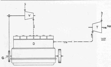
Abb. 6. Schema des «Treibgasverfahrens» mittels Kurbel-Dieselmotor und von diesem angetriebenem Achsialverdichter
