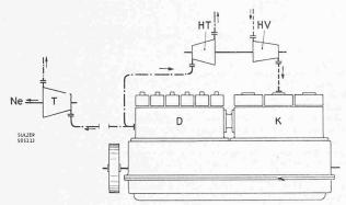
Abb. 9. Schema des «Treibgasverfahrens» mit Vorverdichtung für Aufladedrücke von 6 bis 10 ata. Da die erforderliche Verdichterleistung die Dieselmotorleistung übertrifft, wird ein Teil der Treibgasenergie dazu verwendet, die fehlende Verdichterleistung zu decken.
