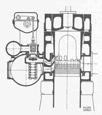
Abb. 3. Schema einer Sulzer-Sonderausführung mit zeitweise erhöhtem Aufladedruck. Der Zylinder wird nach beendigter Spülung und Nachladung über ein gesteuertes Ventil mit Luft höheren Druckes aufgeladen
