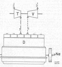
Abb. 4. Schema eines «direkt» aufgeladenen Zweitaktmotors. (Dieses Aufladeverfahren ist beim Zweitaktmotor nicht realisierbar, weil die vom Aufladeaggregat gelieferte Spül- und Aufladeluft beim Anlassen und bei kleinen Lasten nicht genügt
