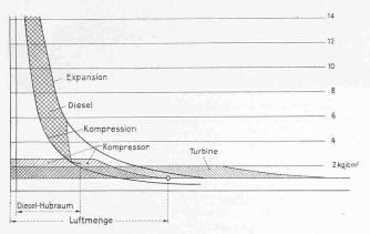
Abb. 11. Unterer Teil des Indikator-Diagramms eines auf 2 ata aufgeladenen Zweitakt-Dieselmotors
