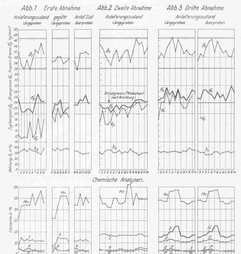
die Lamellen eine Dicke von 20 mm, die Bleche dagegen eine solche von 14 mm aufweisen. Dieser macht sich durch eine merkliche Hebung der Proportionalitäts- und Streckgrenze sowie der Zugfestigkeit geltend, während die Dehnung etwas vermindert wird.
