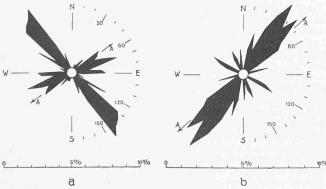
Abb. 2. Kluftrosen, A-A Schieferungsrichtung. a: Zentraler Aaregranit, in der südlichen Partie der Schöllenen, b: Fibbiagranit im Gotthardmassiv Südflanke Monte Prosa
