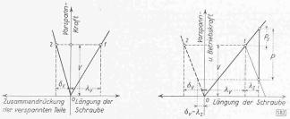
Abb. 7. Formänderungsdreiecke der Schraubenverbindung
