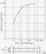
Abb. 12. Einfluss der freien Gewindelänge auf die Dauerhaltbarkeit bei Schlagbeanspruchung von Normalschrauben
