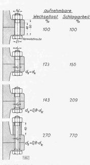
Abb. 25. Verbesserung der Dauerhaltbarkeit der Schraube durch Anwendung der Dehnschraube bei schwingender und schlagartiger Beanspruchung
