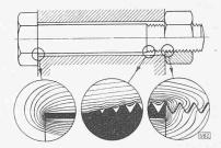
Abb. 5. Die 3 Schwachstellen der Schraube
