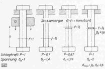
Abb. 30. Schlagbeanspruchung in Bauteilen von veränderlichem Querschnitt
