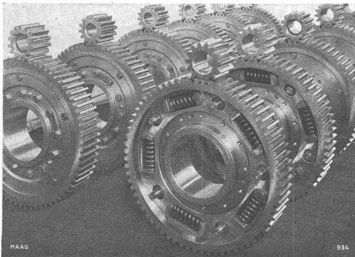
Maag - Protex - Getriebe neuester Konstruktion für die elektrischen Lokomotiven der Südost-Bahn.
