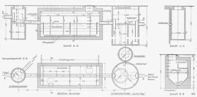
Abb. 2. Oelabscheider für max. 10 l/s Abwassermenge einer Fabrik. — Ing. P. ZIGERLI, Zürich. — Masstab 1:80
