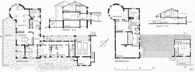
Abb. 2. Grundriss vom Erdgeschoss und Schnitt A-B.
