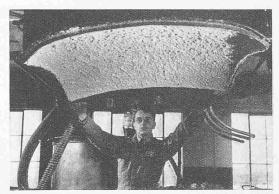
Abb. 2. Rohform eines Dachteiles. Der Kunstharzbrei mit Holz- und Pflanzenfasern vermischt, wird durch Vakuum an ein Drahtgeflecht angesogen und dadurch weitgehend entwässert. Nach Aufhebung des Vakuums wird die Rohform frei und kann in die Presse gelegt werden, wo sie unter Druck und Wärme auf 1/4 ihrer Dicke verdichtet wird
