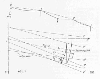
des Seiles, dass die Seilkräfte S' und S'' rechts und links vom Seilschuh gleich gross sind:
