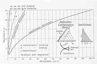
bb. 1 Massenvergleiche der Eisenbetonsperren Holmevann (links) und Navann I (rechts) mit entsprechenden Gewichtmauern
