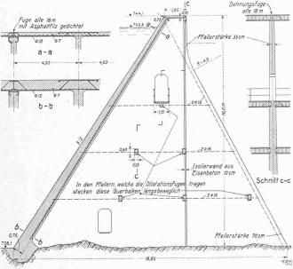
Abb. 4. Mauerschnitte 1:200 der Holmevann-Sperre (mit Isolierwand)
