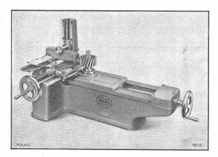
MAAG-Flankenprüfgerät, Type FPV-40, zur Kontrolle des Zahnprofiles von Stirn- und Schraubenrädern.
