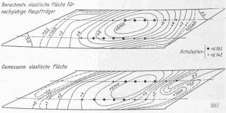
Abb. 14. Elastische Flächen für Belastung durch zwei Lokomotiven
