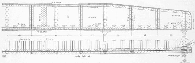
Abb. 3. Teilansicht mit Horizontalschnitt des äussern Hauptträgers. — Masstab 1:70
