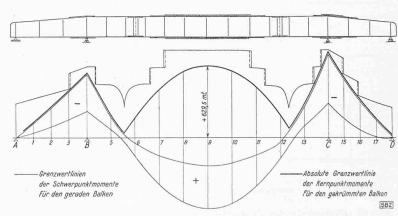
Abb. 9. Momente und Lamellenverteilung für den äussern Hauptträger (Längen 1:300)
