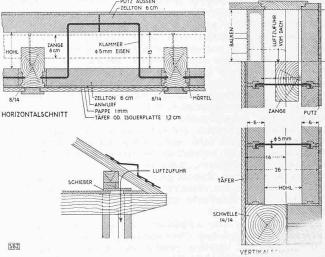
Abb. 1. Trelement-Konstruktion, Schnitte 1:12; Belüftung 1:30
