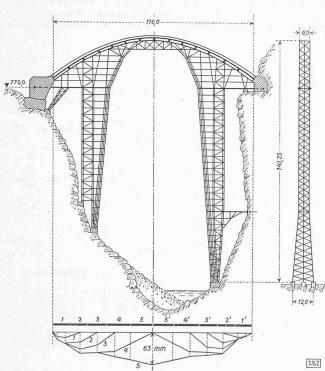
Abb. 2. Lehrgerüst 1:2000. Entwurf und Ausführung R. CORAY, Chur Gemessene Einsenkungen unter der Last des ersten Gewölberinges
