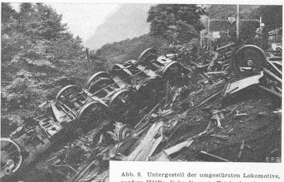
ADD. 9. Untergestell der umgestürzten Lokomotive vordere Hälfte, links die erste Triebachse der hintern, längsverdrehten Hälfte
