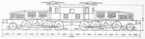
Abb. 4. Typenskizze der SBB-Güterzuglokomotive Ce $^6/_8$  (III). — Masstab 1:150
