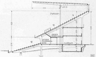
Abb. 4. Schnitt 1:400 durch die Haupttribüne
