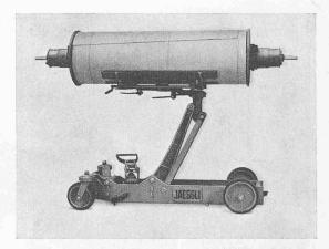
Abb. 45. Hydr. Kettbaum-Transport- und Hubwagen JAEGGLI
