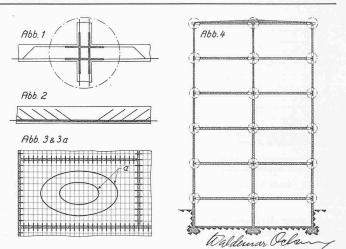
Abb. 1 bis 4. Einbau der «Kopplungsglieder» System Oelsner
