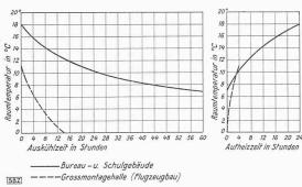
Abb. 2. Auskühl- und Aufheizzeiten von Gebäuden verschiedenartiger Bauweise
