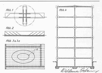
Abb. 1 bis 4. Einbau der «Kopplungsglieder» System Oelsner
