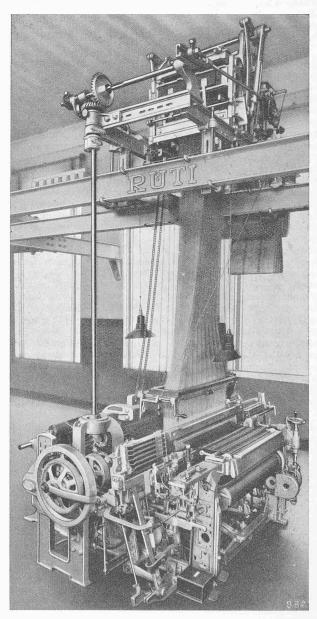
Abb. 29. Sechsschütziger Seidenlancierstuhl mit Jacquardmaschine
