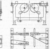
Abb. 15. Gurtenführung für den Spindelantrieb
