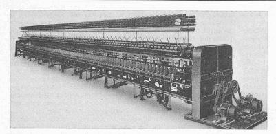
Abb. 14. Ringzwirnmaschine für mittlere und gröbere Woll- und Baumwollzwirne
