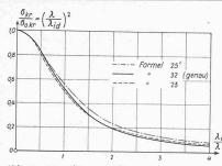
Abb. 12 : Vergleich der Knickspannungen von Rahmenstäben im elastischen Bereich
