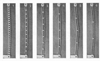
Abb. 24. Die sechs Versuchstäbe unter der Knicklast
