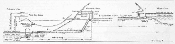
Profil en long de la galerie sous pression et de la conduite forcée reliant le Lac Blanc avec l'usine sur le Lac Noir, avant la transformation décrite dans le texte page 91. — Echelle 1:5000
