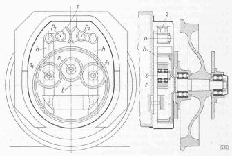
Aperiodischer Einzelachsantrieb der Ansaldo-Werke Genua
