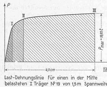
Last-Dehnungslinie für einen in der Mitte belasteten I Träger N° 19 von 1,5m Spannweite
