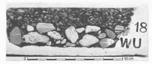
Abb. 5. Schnittfläche durch zweischichtigen, 4,2 cm starken, heiss eingebautem Salviam-Asphaltteerbetonbelag auf der Strasse Oberegg-Heiden, 1938 Untern
