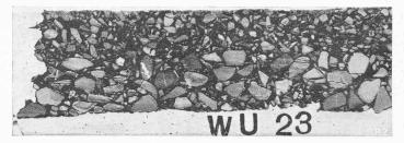
tarken, Abb. 6. Schnittfläche durch zweischichtigen 5 cm starken, nach dem Salviam-Verfahren heiss eingebauten Asphaltteerbetonbelag Unternehmer Gebr. Krämer, Zürich Kügeliloostr. Zürich-Affoltern, 1938
