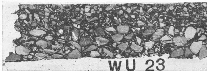
Abb. 6. Schnittfläche durch zweischichtigen 5 cm starken, nach dem Salvia-Verfahren heiss eingebauten Asphaltteerbetonbelag Kügelilostr. Zürich-Affoltern, 1938
